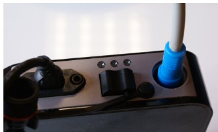
Dugja az úszó kábel végét a konnectorba. Figyelje meg a dugasz és a konnector irányát.
