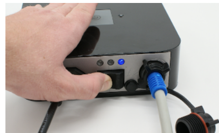
5.2 Szorítsa meg erősen az úszó kábel anyacsavarját. Nyomja meg a kapcsolót a transzformátor borítóján a kék fény alatt. Ez bekapcsolja az áramforrást.
